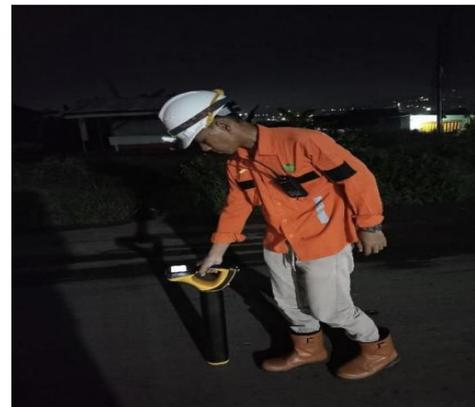
**Gambar 2.** Proses deteksi utilitas bawah tanah menggunakan Pipe & Cable Locator di lokasi proyek SPAM Semarang Barat.
