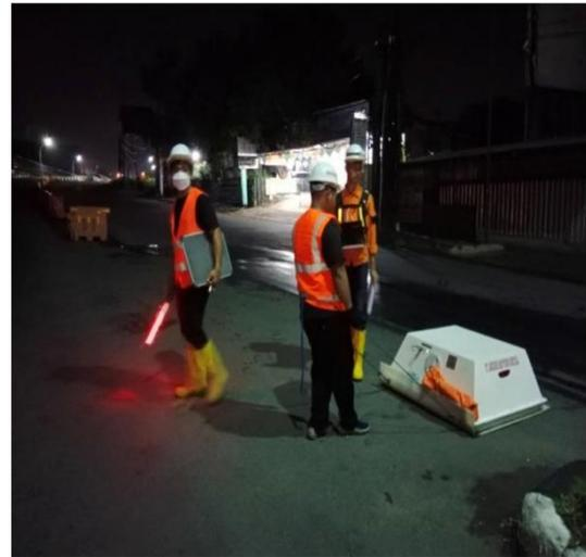
**Gambar 1.** Penggunaan *Ground Penetrating Radar* (GPR) dalam survei utilitas bawah tanah
