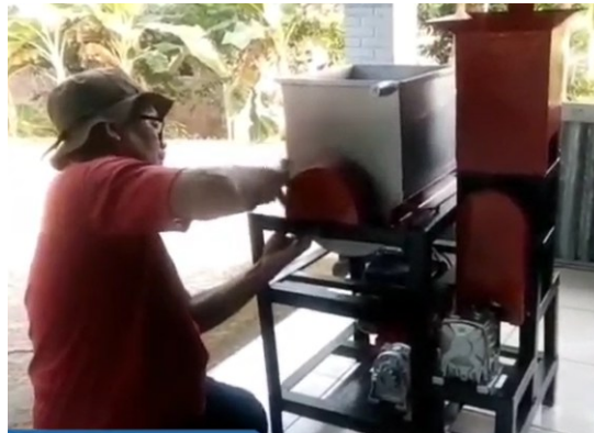
Gambar 5. Proses perakitan mesin pelet apung
