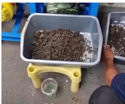
Gambar 6. Hasil Akhir Pupuk dengan Menggunakan Mesin Granulator Sitem Getaran
