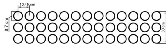
Gambar 1. Susunan kristal sonik kisi persegi berbahan bambu
